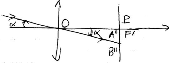
→ image se forme de plan focal image :  $\overline{OP} = f'$
