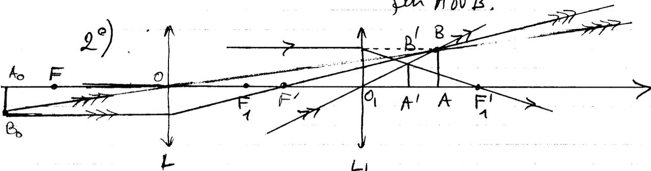
3<sup>o</sup>) Les rayons émergents de L<sub>2</sub> paraissent réellement provenir de l'image A'B'
