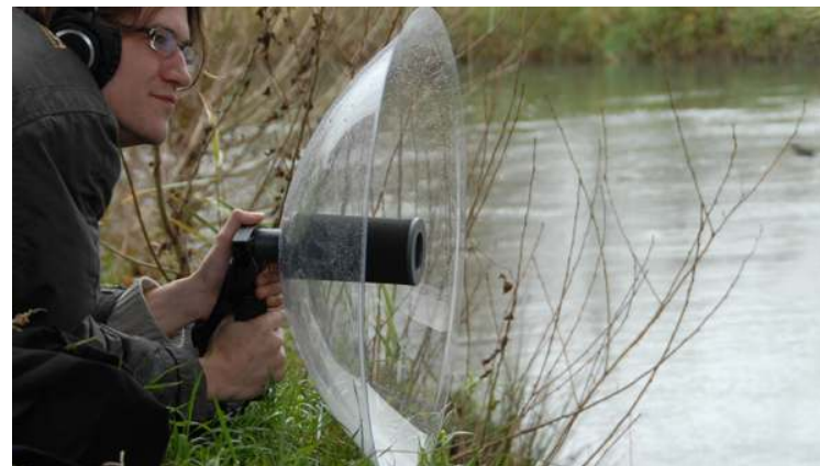
Réflecteur parabolique pour prise de son, par ex. pour entendre le chant des oiseaux
