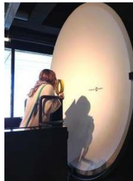
Paraboles à sons de la cité des Sciences : on entend un chuchotement à 17 m !
