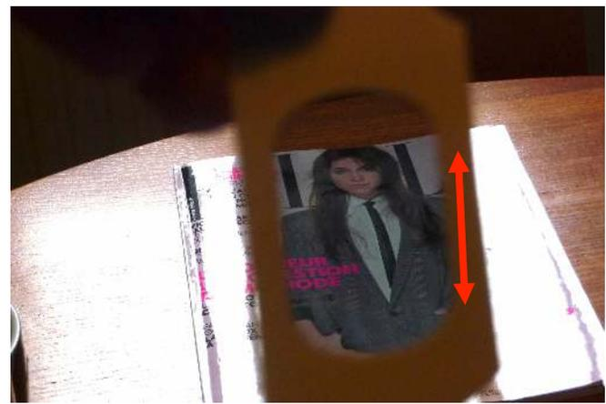
Permet de trouver l'axe de transmission d'un polariseur linéaire !
