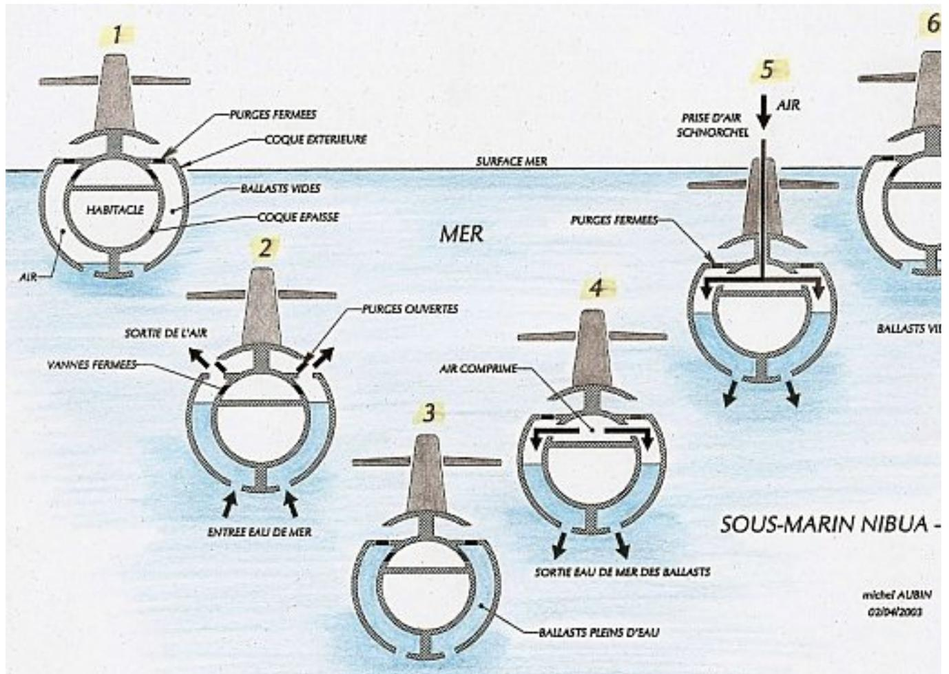
1 En surface, les ballasts sont vides et le sous-marin est émergé. Les purges sont fermées. Le sous-marin est à l'équilibre : la poussée d'Archimède compense son poids.
