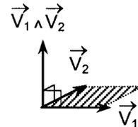
ou encore règle de la main droite (main droite dans sens de  $\vec{v}_1$ , fermer la main dans sens de  $\vec{v}_2$ , le pouce indique  $\vec{v}_1 \wedge \vec{v}_2$ ) ou
