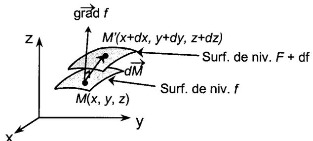
\*  $df = 0$  lorsqu'on se déplace sur la surface  $f = \text{cste}$  = surface de niveau  $f$
