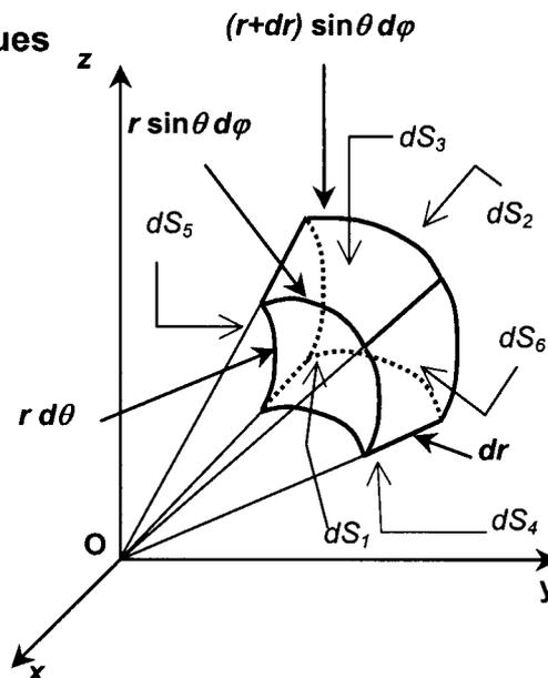
Flux de  $\vec{E}$  à travers les facettes  $dS_1$  et  $dS_2$  perpendiculaire à  $\vec{u}_r$  :  $d\vec{S}_1 = -dS_1 \vec{u}_r$  et  $d\vec{S}_2 = dS_2 \vec{u}_r$ .
