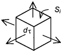
Le flux élémentaire  $dF_{\vec{V}} = F_{\vec{V}}(S(d\tau))$  de  $\vec{V}$  sortant à travers la surface S entourant le volume élémentaire  $d\tau$  est proportionnel à ce volume.
