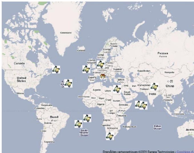
11 satellites GPS (en jaune) visibles par un récepteur situé à Rome le 28 juillet 2008 à 17h20.
